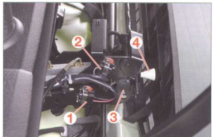
IMPLANTATION DES CONTACTEURS GAUCHE 1. Contacteur de tablette sortie- 2. Contacteur de tablette rangée - 3. Contacteur de toit ouvert - 4. Cordelette afin de rabattre la tablette (mode dégradé)
