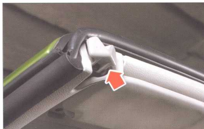
CONTACTEUR DE TOIT VERROUILLÉ/DÉVERROUILLÉ
