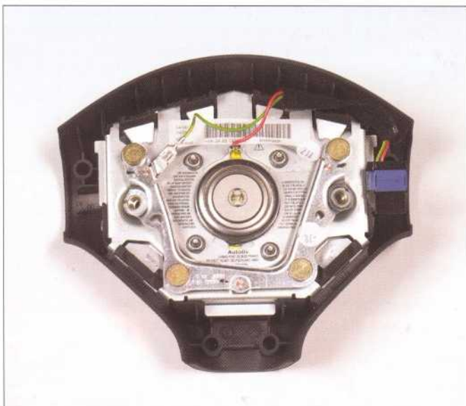
VUE ARRIÈRE DE L'AIRBAG CONDUCTEUR
