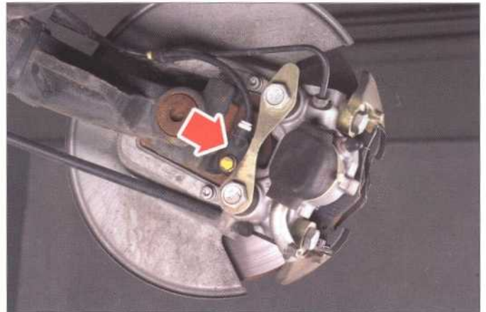
CAPTEUR DE ROUE ARRIÈRE (FREIN À DISQUE)
