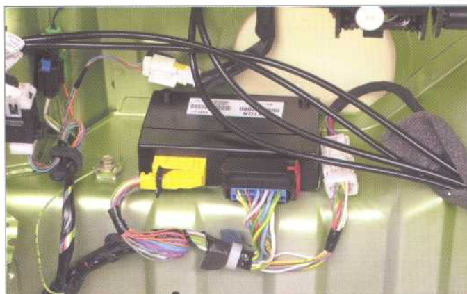
CALCULATEUR DE TOIT ESCAMOTABLE
