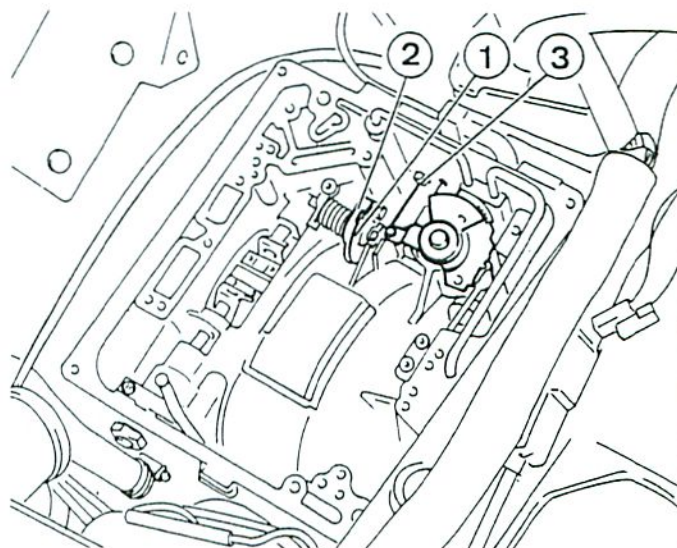
Remplacement du câble de kick-down 1. Câble - 2. Came - 3. Arrêt de gaine
