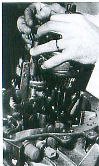
Dépose de l'ensemble pignonnerie-fourchettes.
