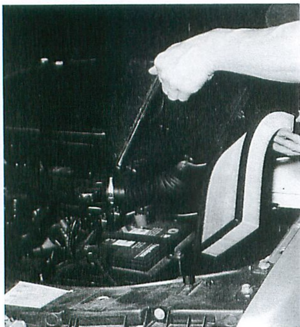
Remplacement de la cartouche filtrante du filtre à air.
