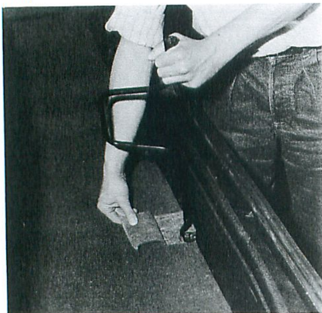
Desserrage de la vis de maintien du berceau de roue de secours.
