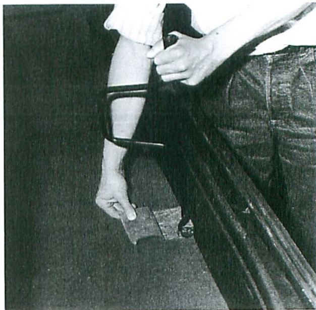
Desserrage de la vis de maintien du berceau de roue de secours (photo RTA).
