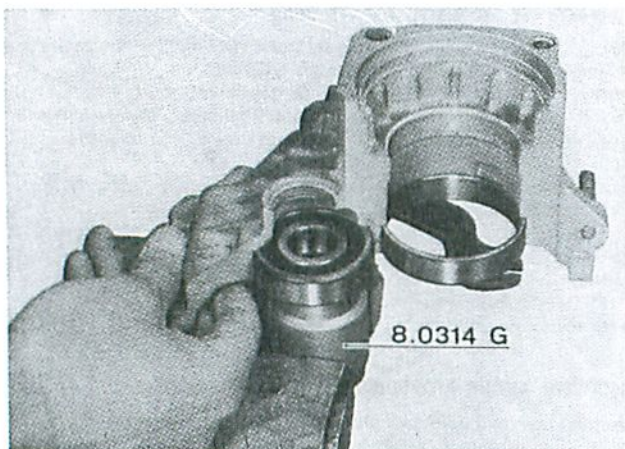
Centrage de la bague intérieure du roulement sur calibre 8.0314 G.
