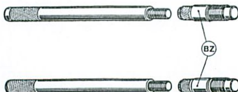
Guides de centrage de la culasse (réf. 8.0115 Y) et jeu de deux embouts BZ
