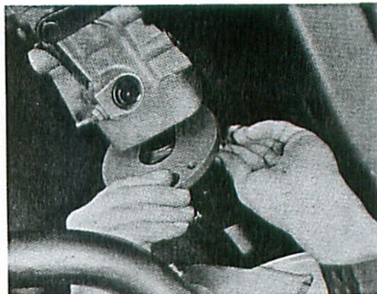
Mise en place de la plaque de maintien de l'arbre de transmission
