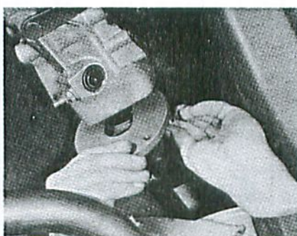
Séparation tube de liaison-boîte et mise en place de la plaque de maintien réf. 8.0403 S.
