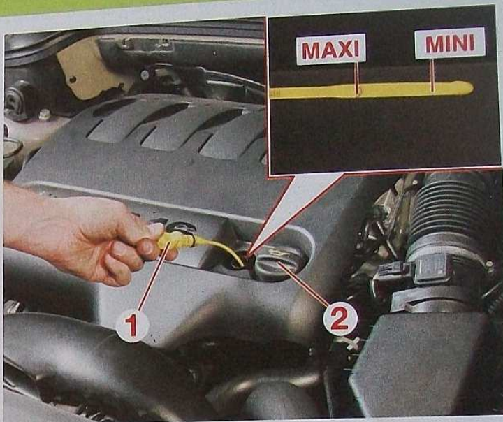
Contrôle du niveau d'huile moteur sur la jauge (moteur 2.0 HDi). L'huile ne doit jamais dépasser le repère « maxi » ou descendre en dessous du repère « mini ».
