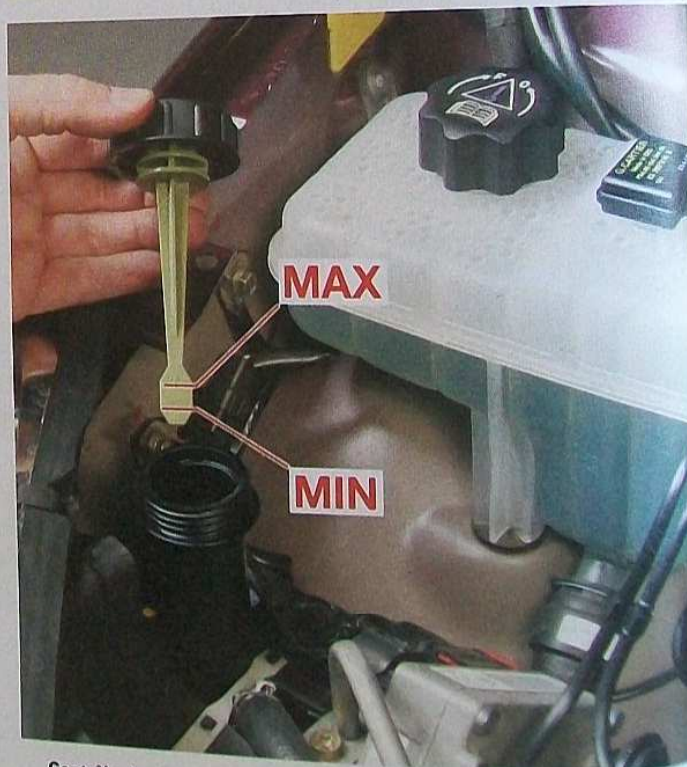
Contrôle du niveau d'huile d'assistance de direction sur le bouchon/jauge. L'huile ne doit jamais dépasser le repère « MAX » ou descendre en dessous du repère « MIN ».
