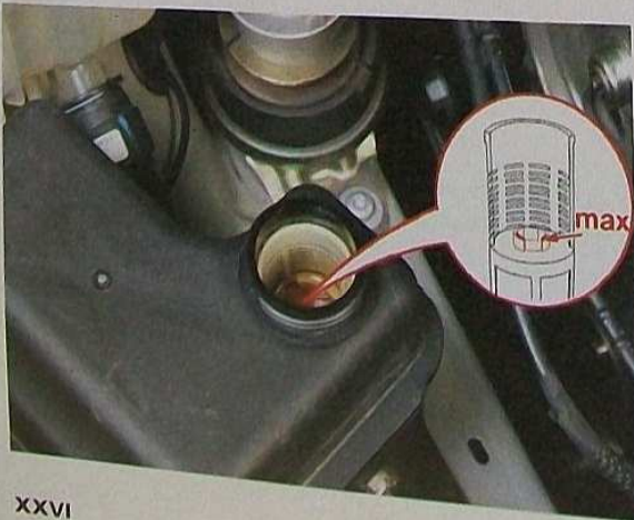
Contrôle du niveau d'huile d'assistance de direction sur le bouchon/jauge. L'huile ne doit jamais dépasser le repère « MAX » ou descendre en dessous du repère « MIN ».
