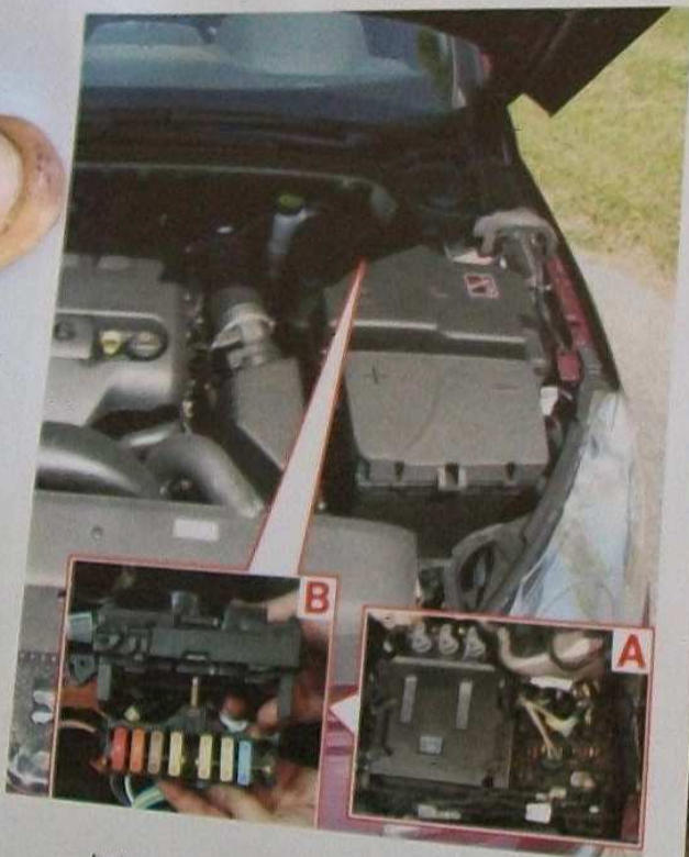
Implantation des fusibles dans le compartiment moteur. A. Boîtier de servitude moteur - B. Platine porte-fusibles maxi.
