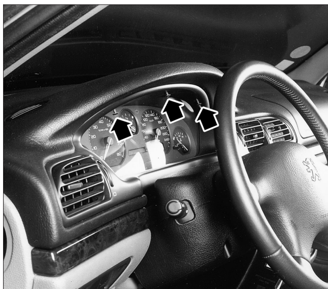
COMBINE D'INSTRUMENT - Dépose des vis de fixation de la visière.
