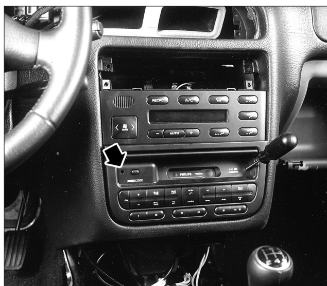
PLANCHE DE BORD Dépose de l'autoradio.
