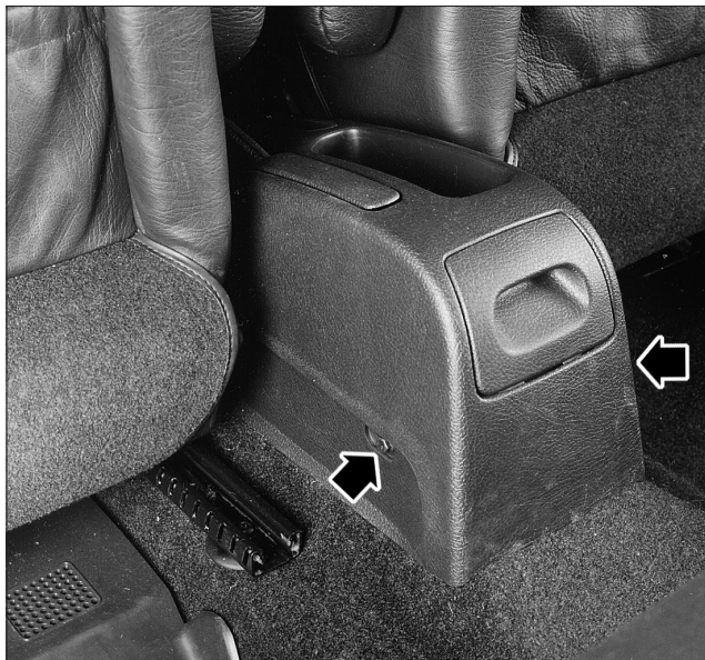
PLANCHE DE BORD - Dépose des fixations arrière de la console de plancher.
