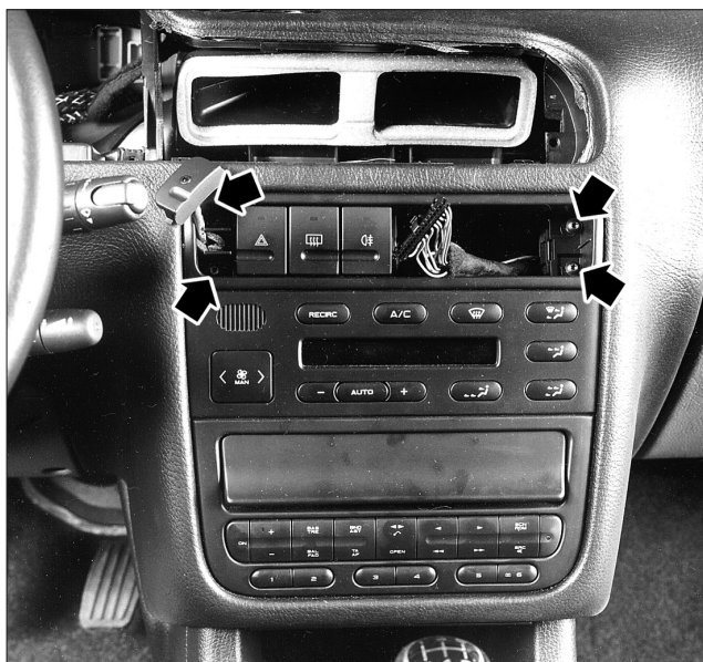
PLANCHE DE BORD Vis de fixation du support d'interrupteurs de console centrale.
