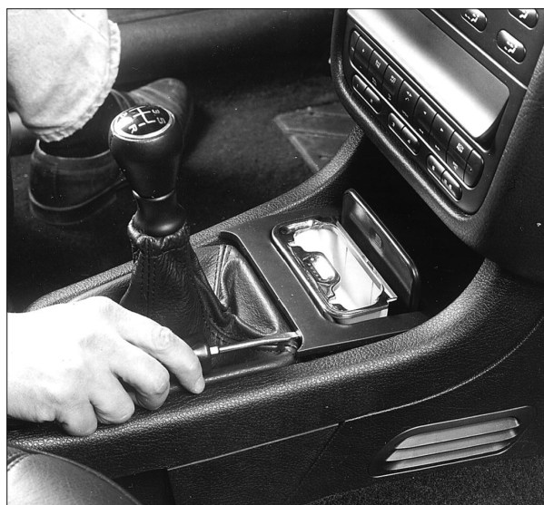
PLANCHE DE BORD - Dépose de l'ensemble fond de console/cendrier.
