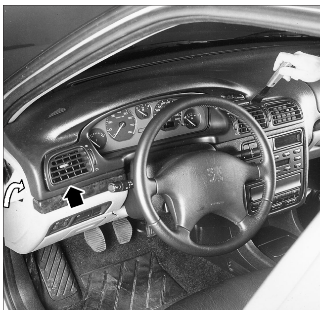
COMBINE D'INSTRUMENT - Dépose de la visière.
