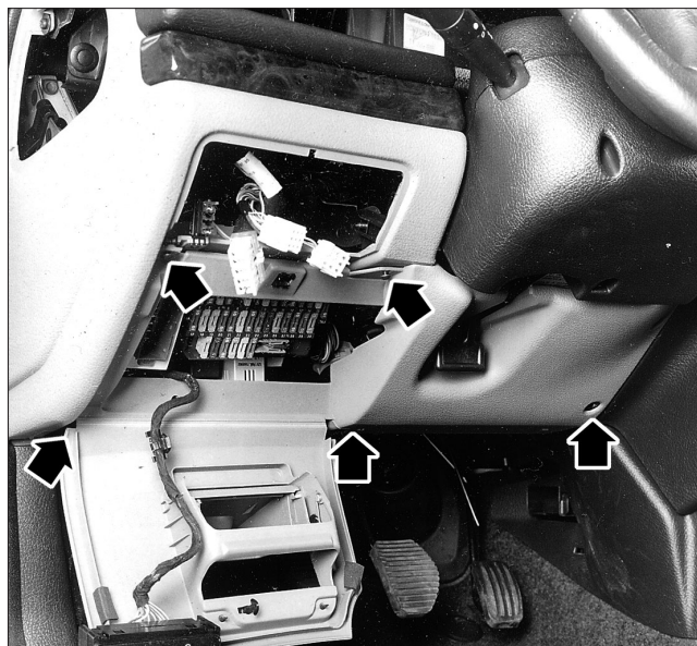
PLANCHE DE BORD - Vis de fixation de la garniture inférieure gauche.
