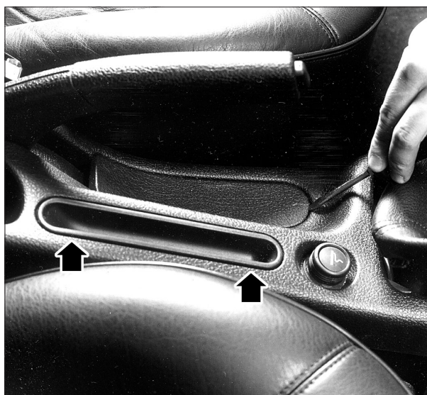
PLANCHE DE BORD - Dépose du cache sous le frein de stationnement.
