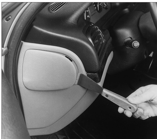
COMBINE D'INSTRUMENT - Dépose de l'obturateur latéral.
