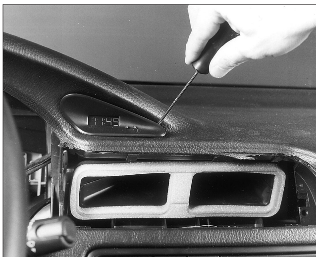
PLANCHE DE BORD - Dépose de la montre.
