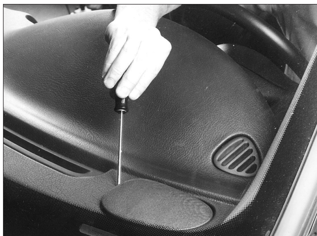
PLANCHE DE BORD Dépose d'un "tweeter".
