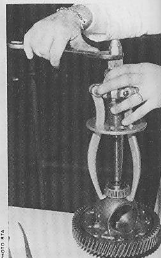
Extraction d'un roulement du boîtier de différentiel.
