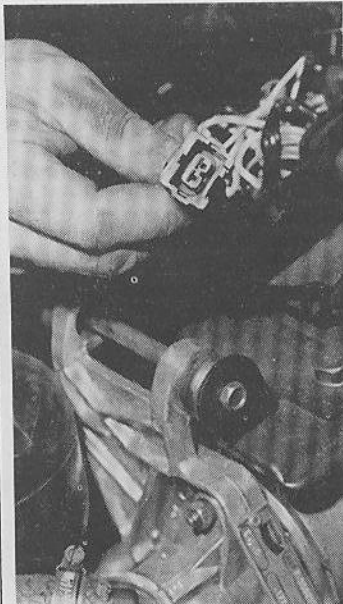
Connecteur M897 (couleur grise) permettant le contrôle du système « ABR ».
