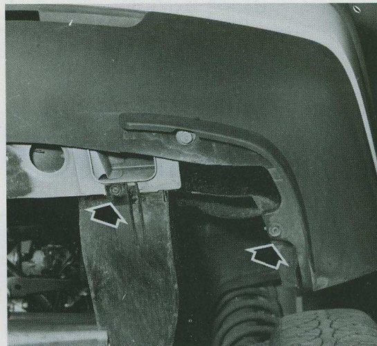
Le pare-boue en plastique est fixé directement sur le longeron avant à l'aide de vis cruciformes, à proximité de l'ancrage de bouclier avant.
