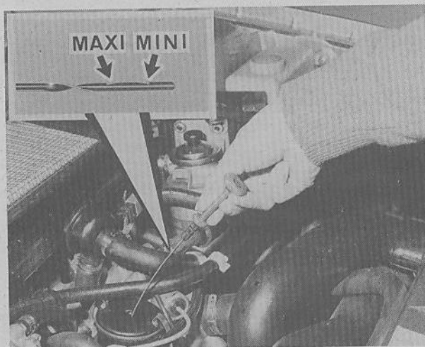
Emplacement de la jauge d'huile moteur et indication de niveau sur la jauge (Photo RTA)
