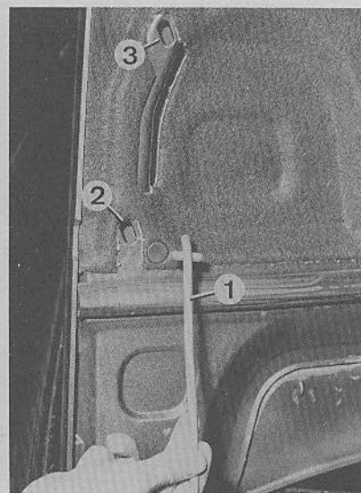
Béquille de maintien du capot (Photo RTA). 1. Béquille - 2. Trou pour ouverture totale (90°) - 3. Trou pour ouverture normale.
