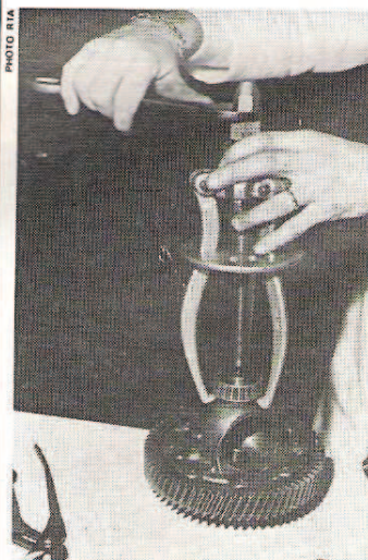
Extraction d'un roulement de différentiel
