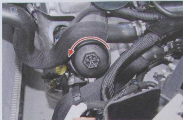
Dépose du couvercle de filtre à huile moteur 1.6 HDi
