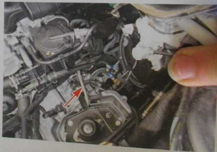
Identification du tuyau de drainage Photo prise bac à batterie déposer pour plus de clarté
