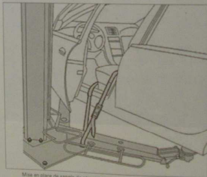
Mise en place de sangle de sécurité sur un pont élévateur à deux colonnes.
