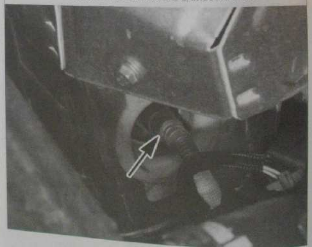
IMPLANTATION DE LA SONDE LAMBDA AMONT
