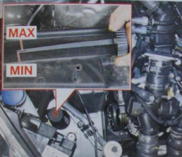
Contrôle du niveau d'huile sur le bouchon/jauge Le niveau doit se situer entre les repères MINI et MAXI.
