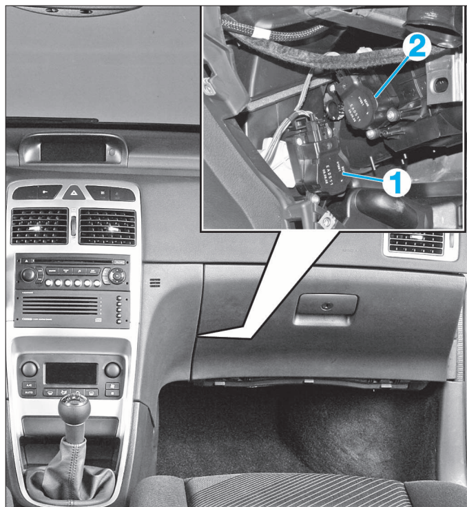
Implantation du volet de recyclage (2) et du volet de distribution d'air (1). Le volet de mixage d'air droit se trouve sous le volet de distribution.
