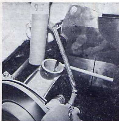
Désengagement du pivot et de la jambe de suspension, clé 8.0903 AE en place
