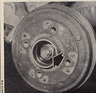
Freinage de l'écrou de moyeu arrière par matage de l'épaulement dans la gorge de la fusée
