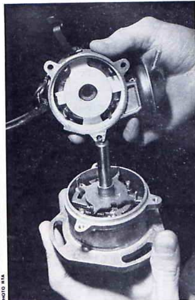
Dépose de la partie supérieure de l'allumeur Ducellier
