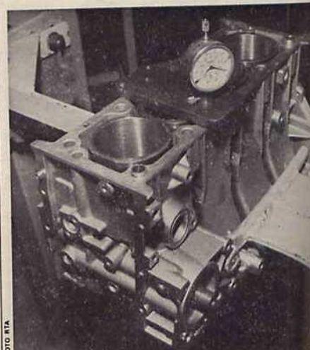
Contrôle du dépassement des chemises
