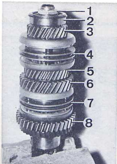
Démontage de l'arbre secondaire serré à l'étau 1. Ecou - 2. Roulement - 3. Pignon de 4 e - 4. Synchro de 3 e -4 e - 5. Pignon de 3 e - 6. Pignon de 2 e - 7. Synchro de 1 e -2 e - 8. Pignon de 1 e
